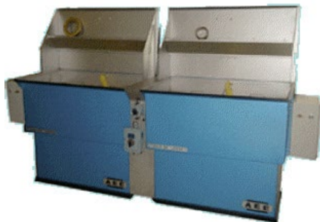
浸泡槽，可使用50%浓度与冷、热水混合进行冲洗
